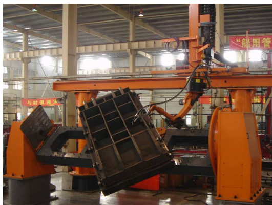
煤矿液压支架结构件 11 轴焊接机器人
