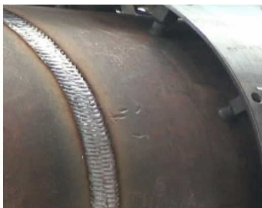
自动焊形成的细密鱼鳞焊缝
